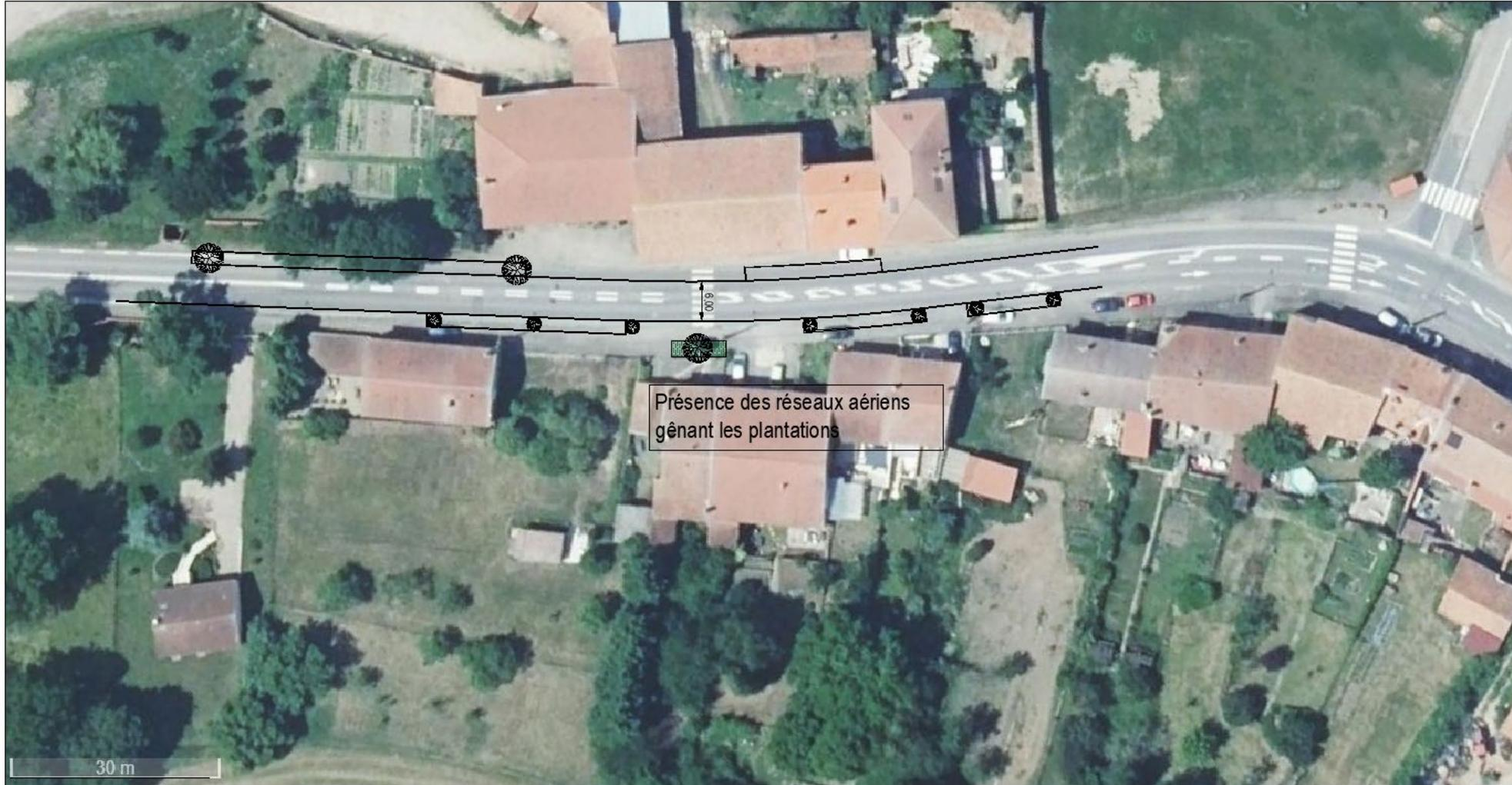
Pose de bordures pour délimiter la chaussée à 6m de largeur. Déplacement des bouches avaloir. Reprise des revêtements de trottoir en plein largeur. Plantation d'arbres fastigiés à développement modéré ou de grands arbustes en raison de la présence des réseaux aériens. Aménagement de places de stationnement clairement délimitées sur trottoir. Longueur 150ml. Surface de travaux: environ 1 000m<sup>2</sup>. Estimation des travaux: 90 000€ HT
