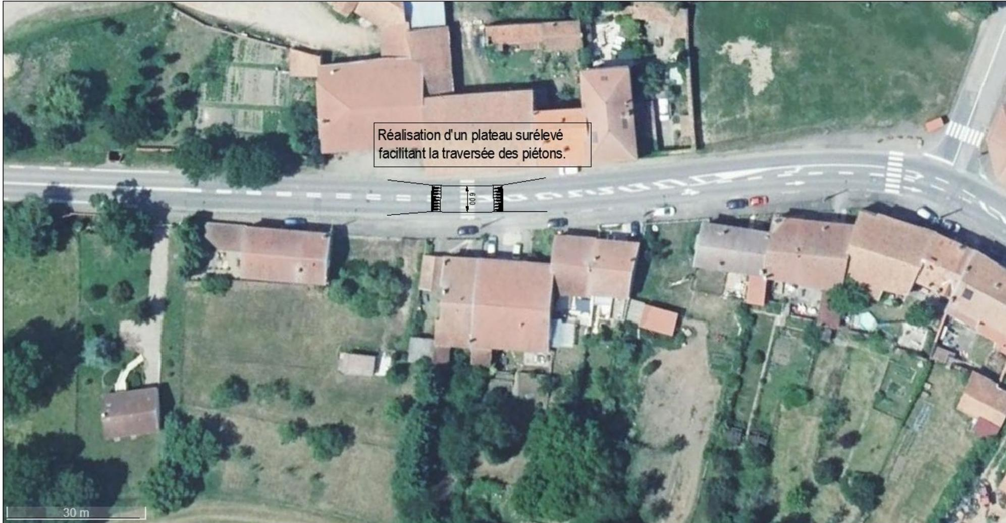
Rétrécissement ponctuel de la chaussée à 6m et création d'un plateau surélevé permettant le ralentissement (à environ 30 à 40km/h) de tous les véhicules et facilitant la traversée des piétons. Longueur mini 12ml. Création d'au moins deux bouches avaloir. Surface de travaux: environ 500m<sup>2</sup>. Estimation des travaux: 35 à 40 000€ HT, y compris reprise des trottoirs au droit du ralentisseur.
