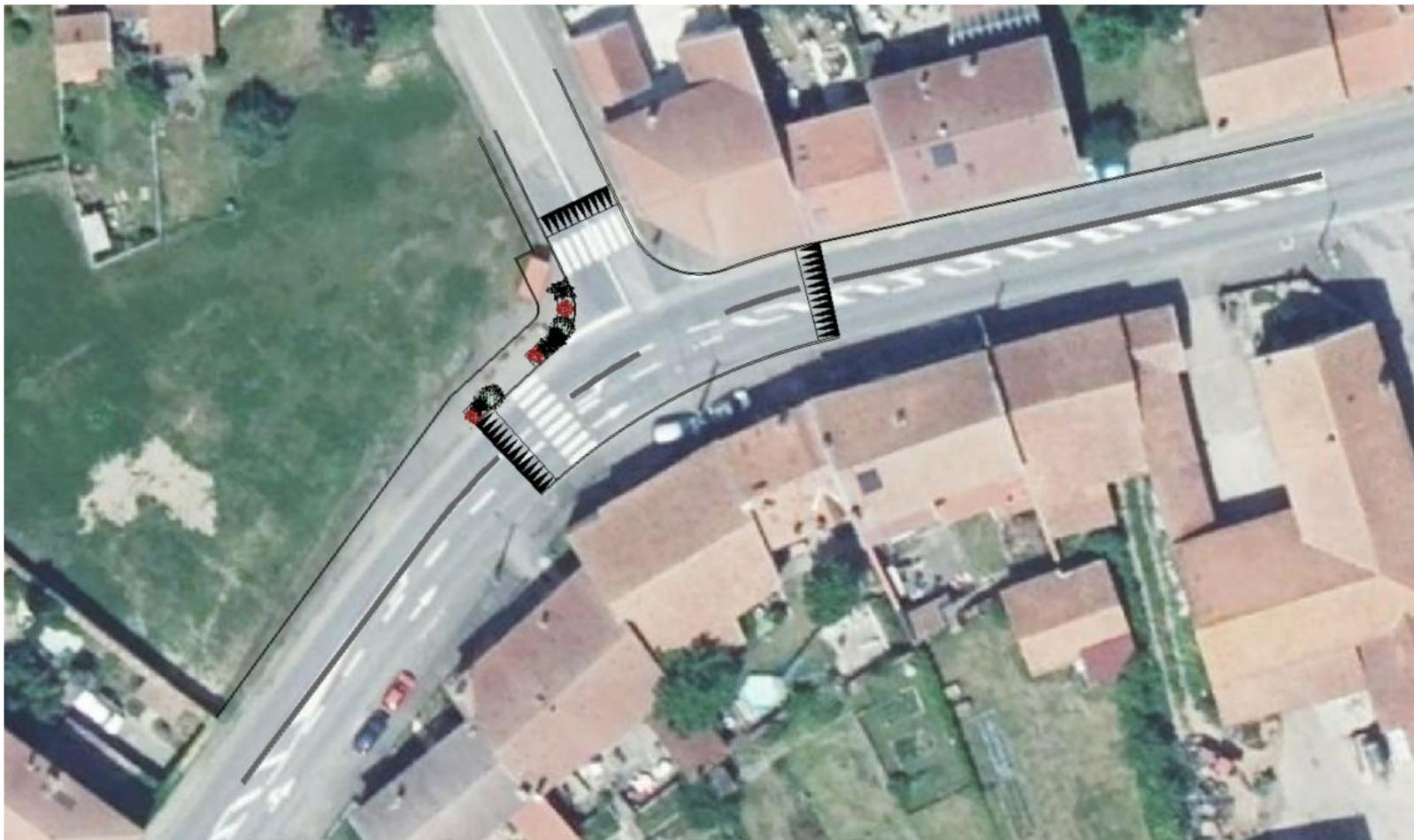
Réalisation d'un plateau surélevé pour marquer le carrefour et faciliter la traversée des piétons. Ce dispositif permettrait également de ralentir la vitesse des usagers. Il aura également la vertu de retenir les eaux de pluie en amont du carrefour.
